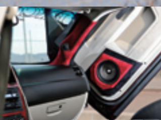
パネル類はペイントされ、Aピラーやフロントドアにはツイーターやミッドスピーカーをインストール。トランクにはウーハーが2基鎮座する。
